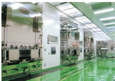
凍結乾燥機および自動搬出入装置
